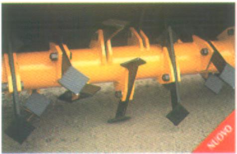
**Nuova Rotore a denti:** Per tutti i tipi di terreno, molto robusto e aggressivo sui terreni asciutti e tenaci, evita l'intasamento sui terreni molto umidi. Grande economia di manutenzione grazie ai particolari denti autoaffilanti reversibili fissati con una sola vite e poco numerosi. Basso assorbimento di potenza non crea suola di lavorazione.
