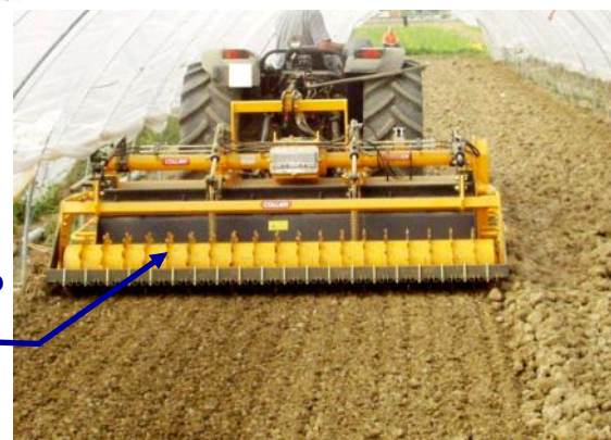
Interrassassi con rullo packer Enterradoras con rodillo packer Steinabscheider mit Rotorpackwalze
