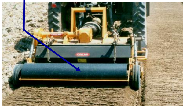
Interrassassi con Baulatrice Stone buriers with bed former Enfouisseur avec préparation de lits de semence
