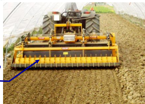
Interrassassi con rullo packer Stone buriers with packer roller Enfouisseur avec rouleau packer
